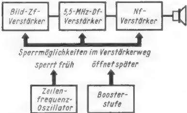
Bild 2. Zum Unterdrücken des Einschaltbrumms wird vorübergehend eine Verstärkerstufe gesperrt
