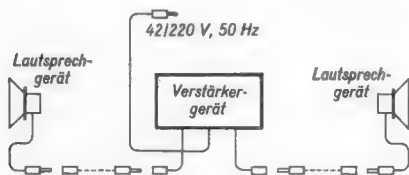
Bild 1. Schema der Wechsel-Lautsprech- und Arbeitsgeräusch-Übertragungsanlage der SEL
